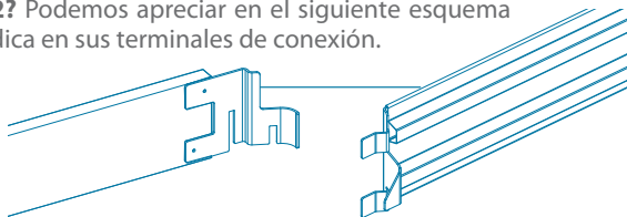
DETALLE TERMINAL RODAPIE GALVANIZADO AMD
